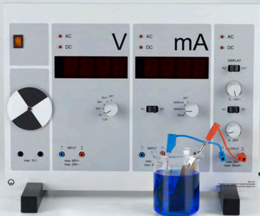
Galvanisation of a metal (C4.4.6.1)
